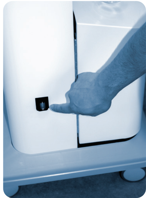
Fig. 7 - Schalter (EIN/AUS) an der Seite der Einheit
