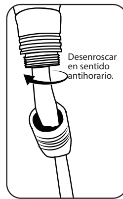
Fig.15 - Para quitar el accesorio de baja velocidad del motor de aire
