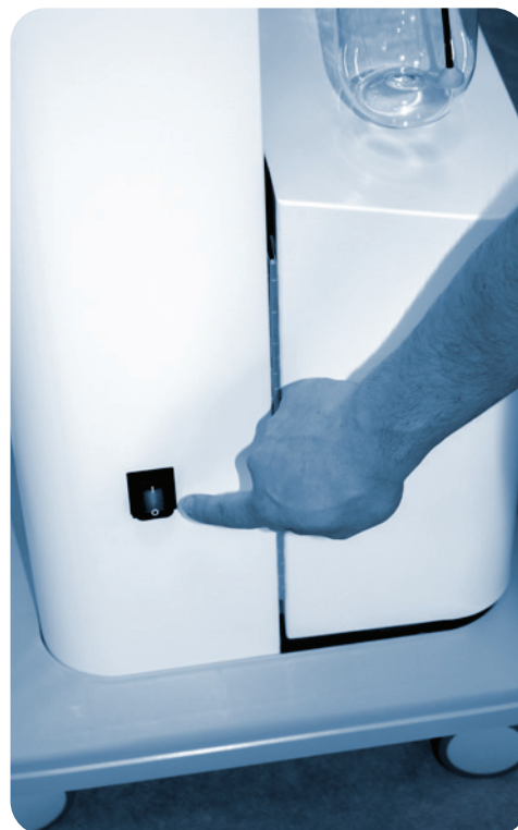
Obr. - Přepínač (ZAP./VYP.) umístěný na boku jednotky
