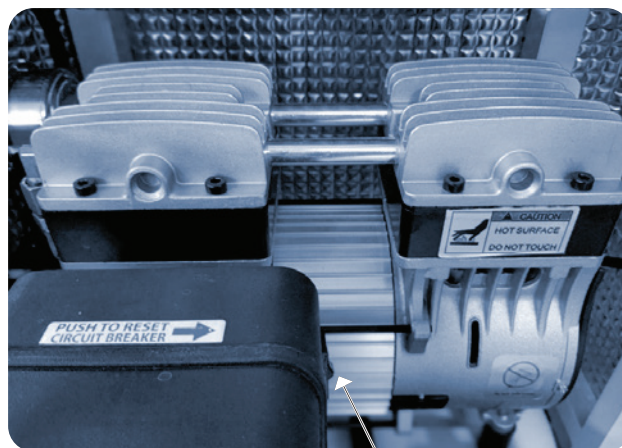
INTERRUTTORE AUTOMATICO: PREMERE PER RIPRISTINARE
