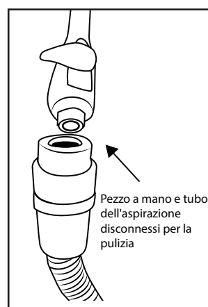
Fig.24 - Il pezzo a mano e il tubo dell'aspirazione possono essere disconnessi per scopi di pulizia.
